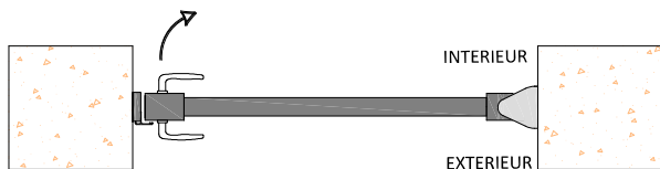
PROFIL DE RECEPTION POUR GACHE MANUEL AVEC BATTUE TOUTE HAUTEUR
