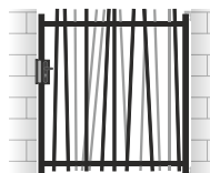
Version n.° 2 BARREAUDAGE SANS LE SOUBASSEMENT TÔLÉ
