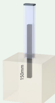
POTEAU 76x41 à sceller avec tube 30x30 acier Longueur 500mm Hauteur maxi conseillée 1.100mm
