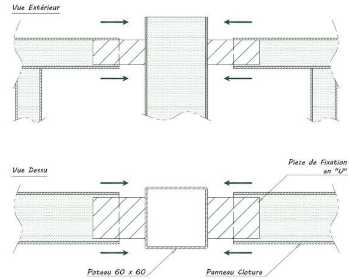
Système de fixation avec des « U 's » métalliques qui offre facilité d'assemblage et esthétiquement avec une fixation discrète entre le poteau et le panneau.
